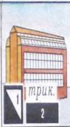
Заводы, фабрики и мельницы без труб: 1) не выходящими в масштабе карты 2) выходящими в масштабе карты
